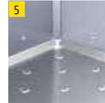
vollhygienischer Edelstahlboden DIN 1.4509 in kreisverpresst, rutschfest genoppter Ausführung, Flächenlast 2000 kg/m<sup>2</sup>
