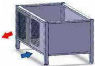
Be- und Entlüftung an der Bedienseite ist nur mit optional erhältlichem Fußgestell oder breitem Maschinenfach möglich
